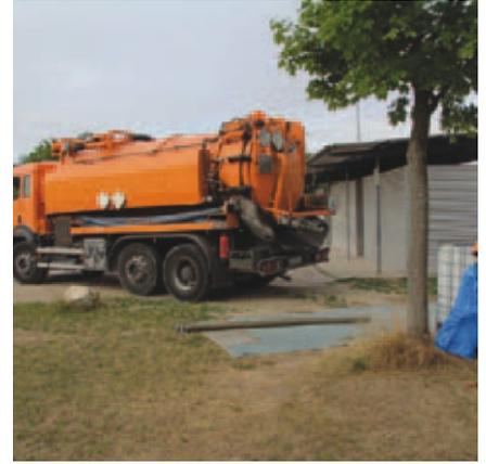
JATI EDD 2-Komponenten-Konzentrat wurde im 1.000 l IBC angemischt, vom bereits mit Leitungswasser gefüllten Tankwagen aufgenommen und so zu einer 3%-igen Lösung verdünnt.
